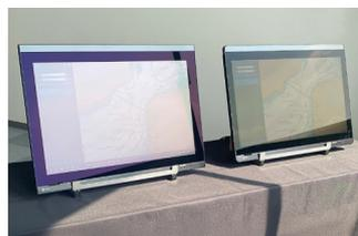
À gauche : Sans liaison optique, 500 cd/m<sup>2</sup> (avec verre de protection) / Droite : Avec liaison optique, 350 cd/m<sup>2</sup> (avec verre de protection)
